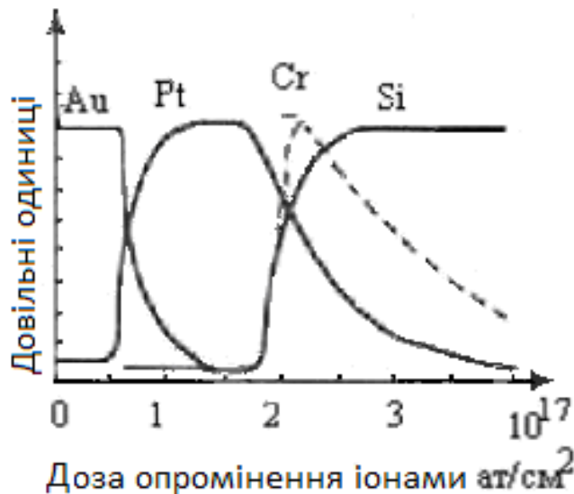
Рис. 4.14. Профілі багатoshарової структури з тонких плівок Au / Pt / Cr, нанесених на Si-підкладці
